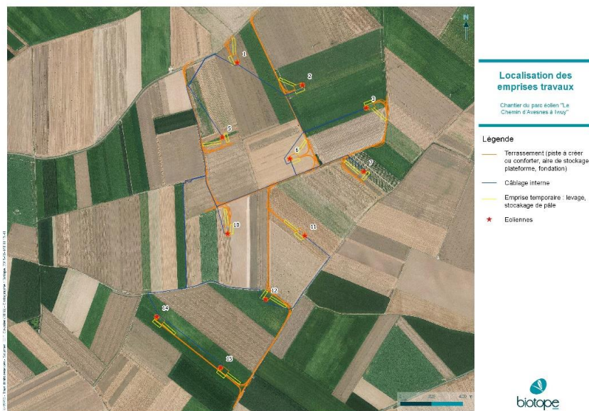
Figure 1 : Localisation des emprises travaux sur le chantier de parc éolien « Le Chemin d'Avesnes à Iwuy »
